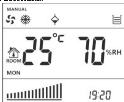
Zdjęcie (5-1) Włączona wentylacja, chłodzenie oraz spust wody
