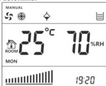
Zdjęcie (5-1) Włączona wentylacja, chłodzenie oraz spust wody
