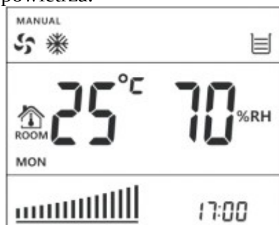
Zdjęcie (4-1) Zbiornik wody pełny
