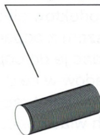
Rura wylotu powietrza
