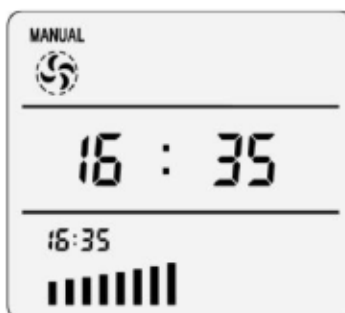
Zdjęcie 10-3 klimatyzator działający w funkcji chłodzenia wstępnego
