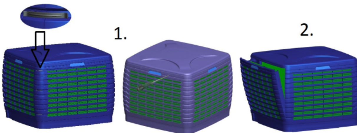
Rys. Przedstawia sposób demontażu ścian bocznych z wkładami celulozowymi. W pierwszym etapie (1.) ściągamy zatrzaski, a następnie (2.) zdejmujemy ściany boczne.
